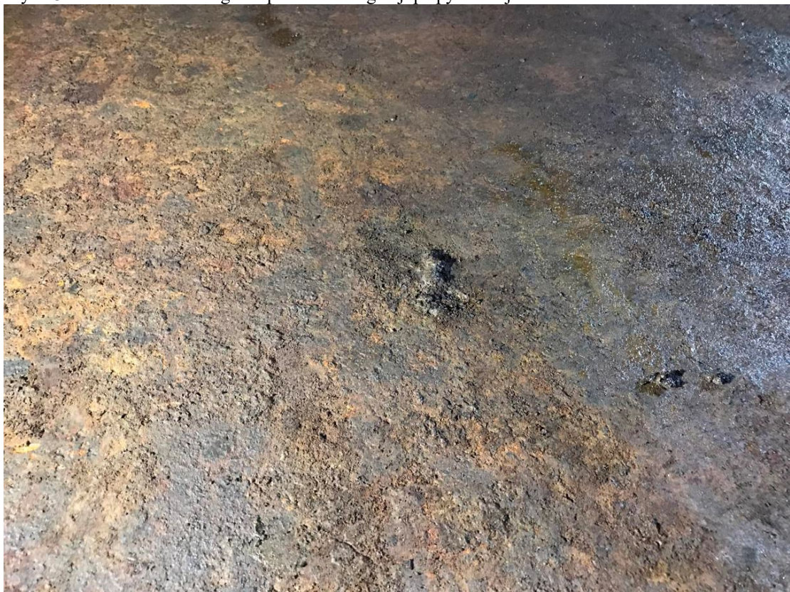
Mynd 4. Suðu ummerki má finna víða og á miðri plötu. Fjarlægja þyrfti slíkt fyrir næstu mælingu.
